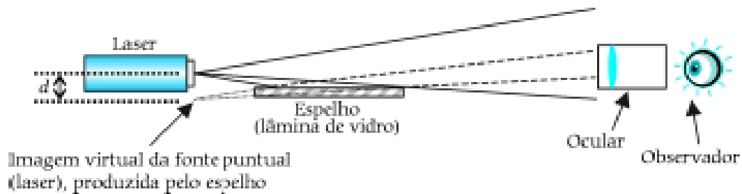
Figura 7. Construção do experimento da interferência da luz.
