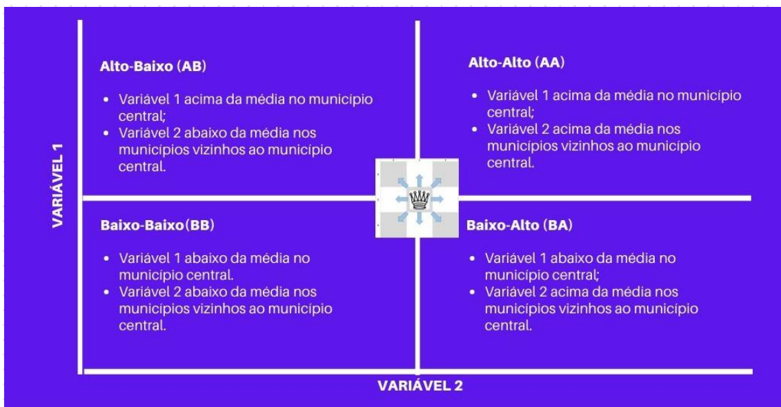
Figura 4- Representação esquemática do diagrama de Moran para dispersão espacial bivariada, considerando movimento de rainha em 1ª ordem para a matriz de contiguidade. Elaboração própria.
